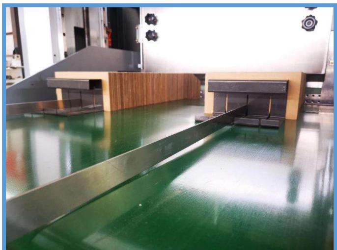
縦仕切り板のセッティングはガイドを定規で調整を行い、横仕切り板のセッティングはタッチパネルでパラメータを入力して行います。
