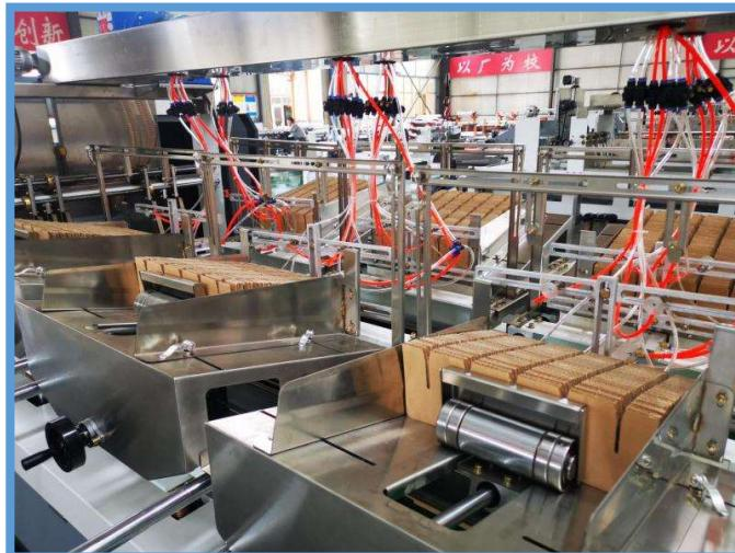
縦方向の仕切り板はエアー吸盤でピックアップし、横仕切り板はシリンダー供給としており、高速運転に対応しています。
