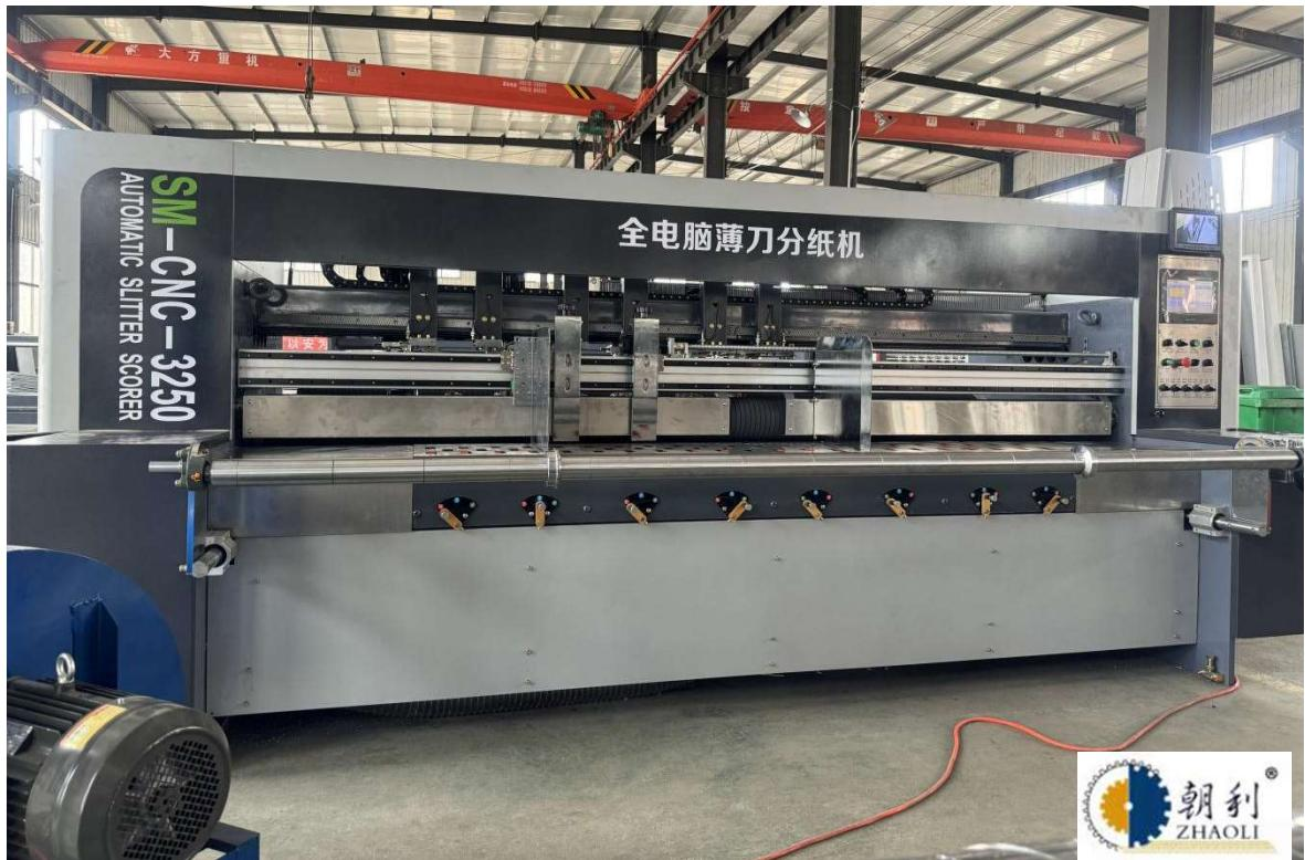
CNCスリッターはサーボモーターを搭載した自動セッティング機能を搭載したオペレータを選ばない革新的なシステムです。
