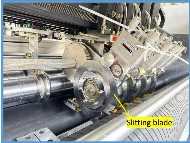
スリッターナイフは高品質のタンガステン鋼合金ブレードを使用しており、長寿命かつ美しいカット面を実現しています。また、自動/手動研磨機能も付いています。
